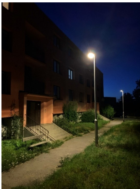
Obr.2 Ukázka omezení rušivého světla použitím vhodné optiky svítidla soustavy VO
