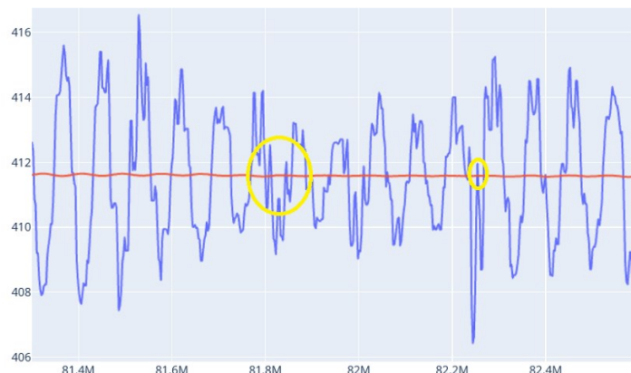
Obr.3 Příklad detekce period metodou průchodu plovoucí střední hodnotou. Ve vyznačených žlutých oblastech lze pozorovat výkyvy způsobené zkreslením a malým rozkmitem potkávacích svítilen v daném bodě testovacího cyklu
