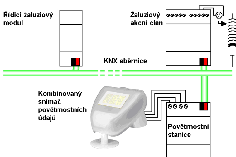
Obr. 1: Principiální zapojení pro samočinné řízení provozu žaluzií
