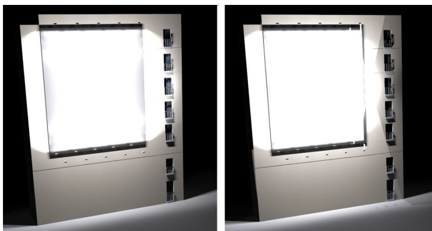
Obr.4 Osvetlenie reklamy inštalovanej na dome: bez použitia clony (vľavo), s použitím clony
